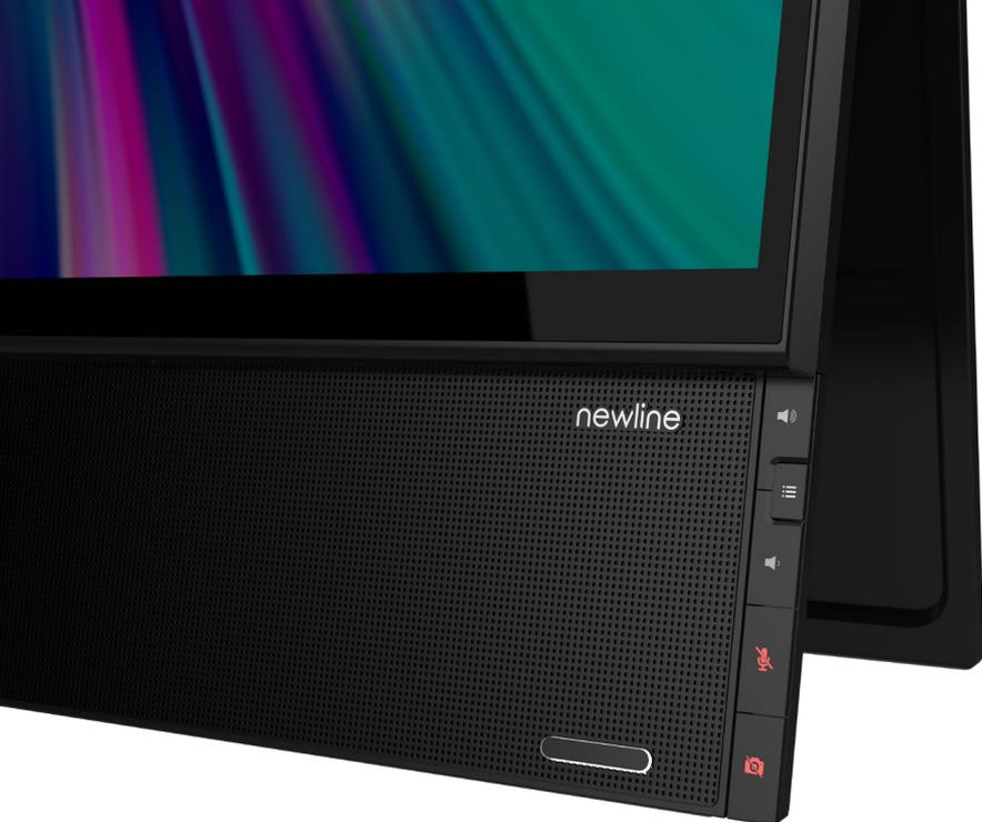
*I tasti fisici consentono di disattivare la webcam e i microfoni, di regolare il volume e accedere al menu di sistema.*
