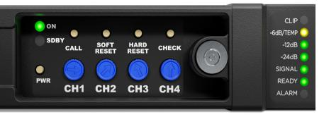
La parte sinistra del pannello frontale come appare dopo aver rimosso il frontalino magnetico. Da sinistra, sono visibili: il pulsante di accensione (PWR), il tasto Call (per utilizzi futuri), Soft Reset, Hard Reset e Check (per avviare l'autoverifica). Sotto in pulsanti, in blu, i controlli di attenuazione dei canali (CH1, CH2, CH3 e CH4).
