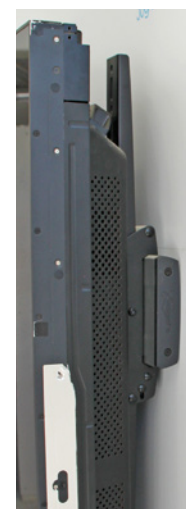
Un particolare della staffa Vogel's utilizzata per appendere alle pareti i monitor.
