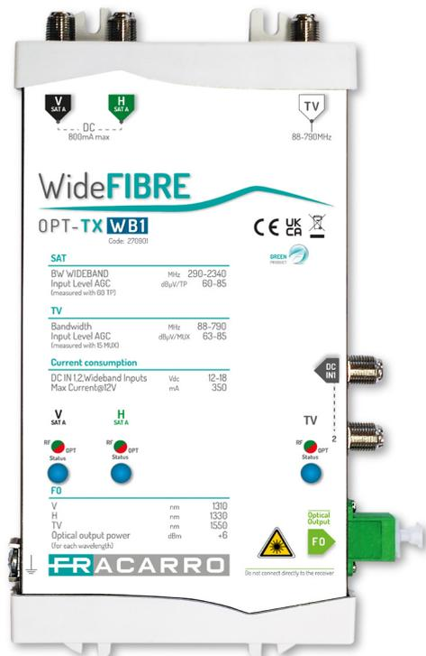
*Il trasmettitore ottico OPT-TX WB1 (codice 270901) distribuisce i segnali provenienti da una posizione satellitare completa.*
