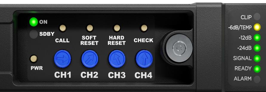
La parte sinistra del pannello frontale come appare dopo aver rimosso il frontalino magnetico. Da sinistra, sono visibili: il pulsante di accensione (PWR), il tasto Call (per utilizzi futuri), Soft Reset, Hard Reset e Check (per avviare l'autoverifica). Sotto in pulsanti, in blu, i controlli di attenuazione dei canali (CH1, CH2, CH3 e CH4).
