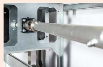
Il movimento viene trasmesso alle pulegge esterne tramite tubi in alluminio e giunti cardanici, indispensabili per allineare con precisione i vari centri di rotazione.
