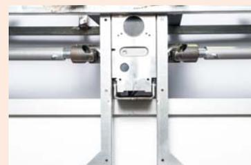
La parte centrale della trasmissione del movimento: al centro il motore, attraverso i giunti cardanici muove le due pulegge laterali che, attraverso i nastri di acciaio, azionano il tubo sul quale è avvolto il telo.
