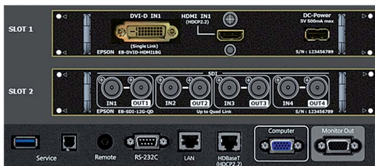
Interfacce AVC. A destra la dotazione standard delle interfacce di collegamento; a sinistra i moduli opzionali per ottenere una connettività su misura
