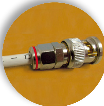
Il conduttore intestato sul cavo.
