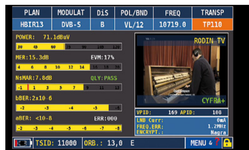
Nota: in modalità ottica è possibile analizzare lo spettro e misurare solo transponder Verticali di Banda Bassa (VL).
