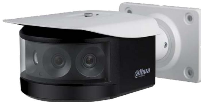
resistenza all'urto meccanico è IK10, equivalente ad una forza di 55 kg. La temperatura operativa varia da -30° C a + 60° C con umidità del 95%. Con la termoresistenza dedicata si possono raggiungere i -40 °C.
