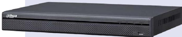
Un registratore video digitale in tecnologia HDCVI, sviluppata da Dahua, che sfrutta il cavo coassiale per realizzare impianti di videosorveglianza HD analogici, anche di grandi dimensioni. Supporta fino a 16 canali (ingressi HDCVI/CVBS), 8 canali (camere IP aggiuntive), 16 canali (local live-view) e 16 canali in riproduzione.
