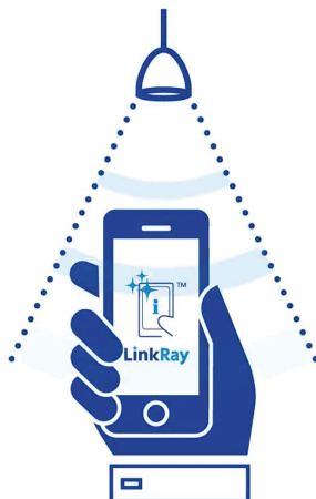
La tecnologia LinkRay sfrutta una fonte di luce a Led per interagire con uno smartphone.
