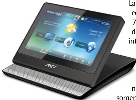
La gestione di tutto l'impianto è concentrata in questo touchpanel 7", un multitouch capacitivo da tavolo con dockingstation integrata, distribuito da Comm-Tec Italia. Presenta una risoluzione 800x480 WVGA LCD, con interfaccia grafica personalizzabile, ed è versatile nella gestione dei segnali: accetta sorgenti video in ingresso come
