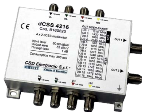
dCSS 4216: multiswitch in cascata a due derivate, ciascuna da 16 user band.
